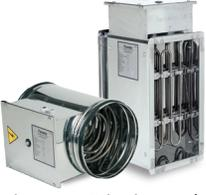
Soğuk iklimlerde ısı geri kazanım cihazı çıkışında ve çok soğuk iklimlerde donmaya karşı taze hava girişinde kullanılmaktadır. Sistemdeki kanal tasarımına bağlı olarak dikdörtgen veya dairesel kesitli üretilmektedir. Standart olarak galvaniz sac ve paslanmaz rezistanslardan oluşmaktadır. Ayrıca, paslanmaz sac gövdesi mevcuttur.
